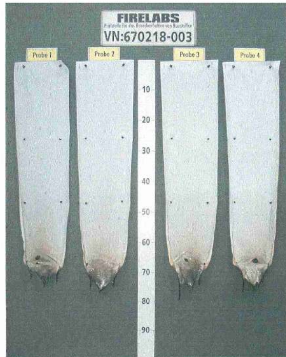
Bild 6 Aussehen des Probekörpers nach dem Brandversuch
